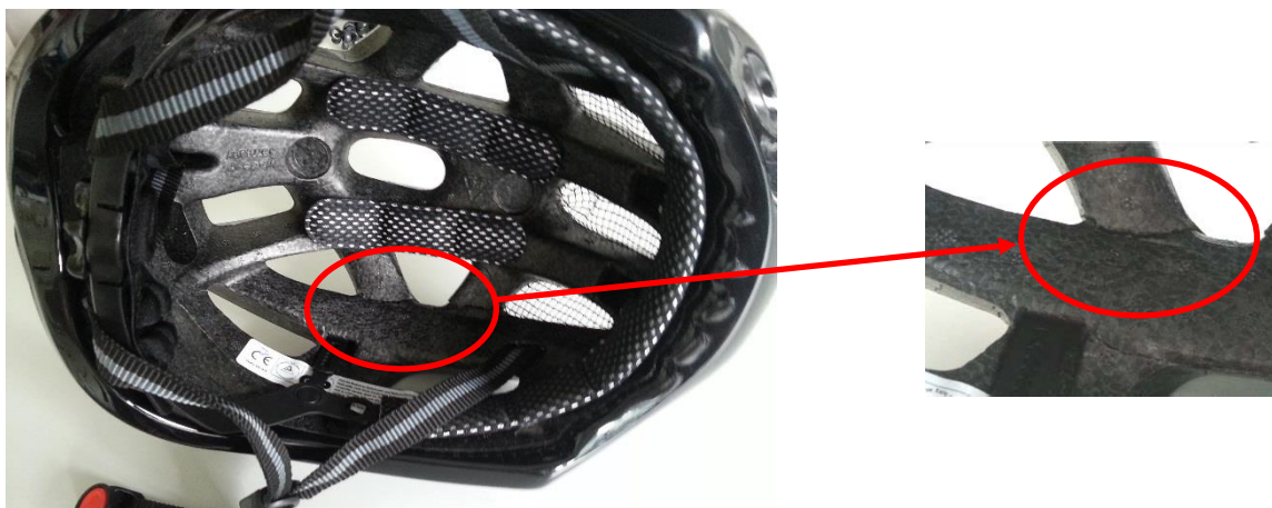
Abbildung 2-35: Riss des Helms im Realversuch
