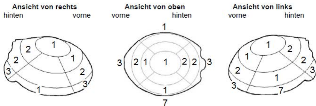
Abbildung 1-42: Lokalisation von Beschädigungen am Helm (UKM, n=9)
