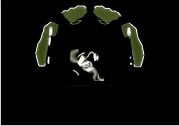
Abbildung 2-7: Maske des Schaumstoffs nach der Operation Region-Growing
